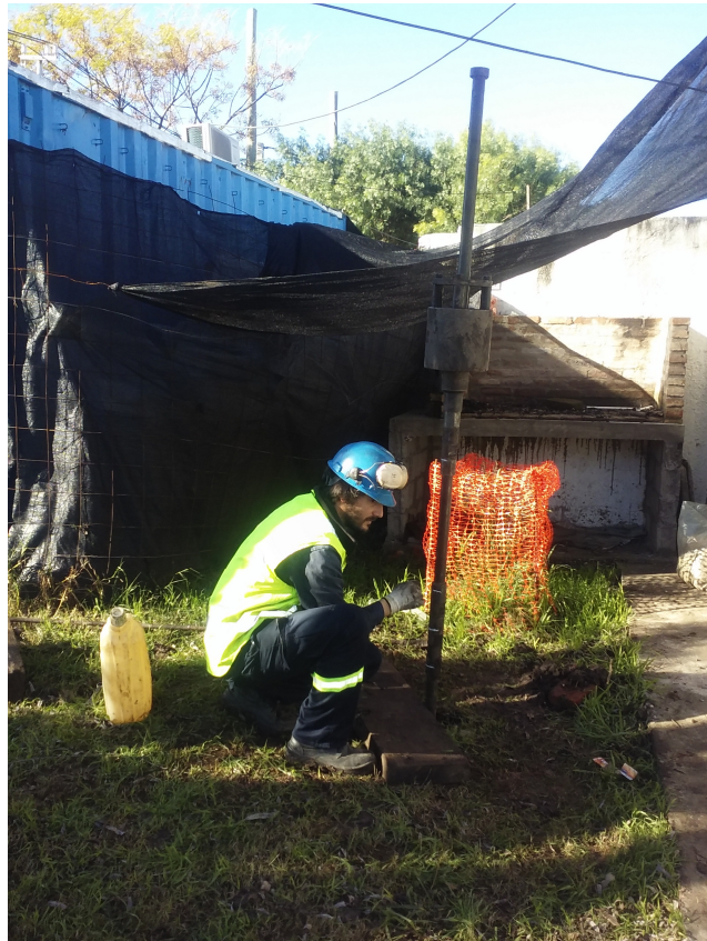
ILUSTRACIÓN 5 – TAREAS DE REALIZACIÓN DE ENSAYO SPT
